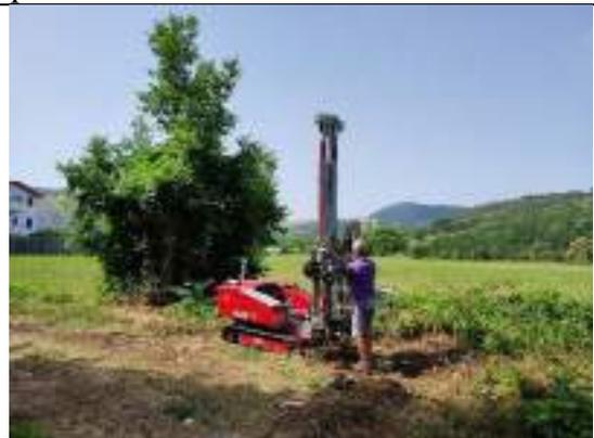
*Prova penetrometrica statica CPT02*
