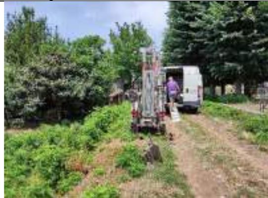
*Prova penetrometrica statica CPT03*
