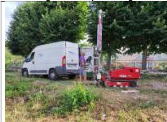
*Prova penetrometrica statica CPT01*
